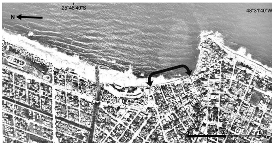
Figura 2. Setor da praia central de Matinhos (indicados com as setas) onde se recomenda o recuo da ocupação para restabelecer o arco-praial e resolver o problema recorrente de erosão.
